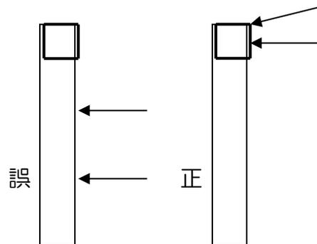
管体の一番上に、金属が厚くなっている部分があるので、そこをたたきます。決してベルの管体をたたかないで下さい。（管が凹みます）
